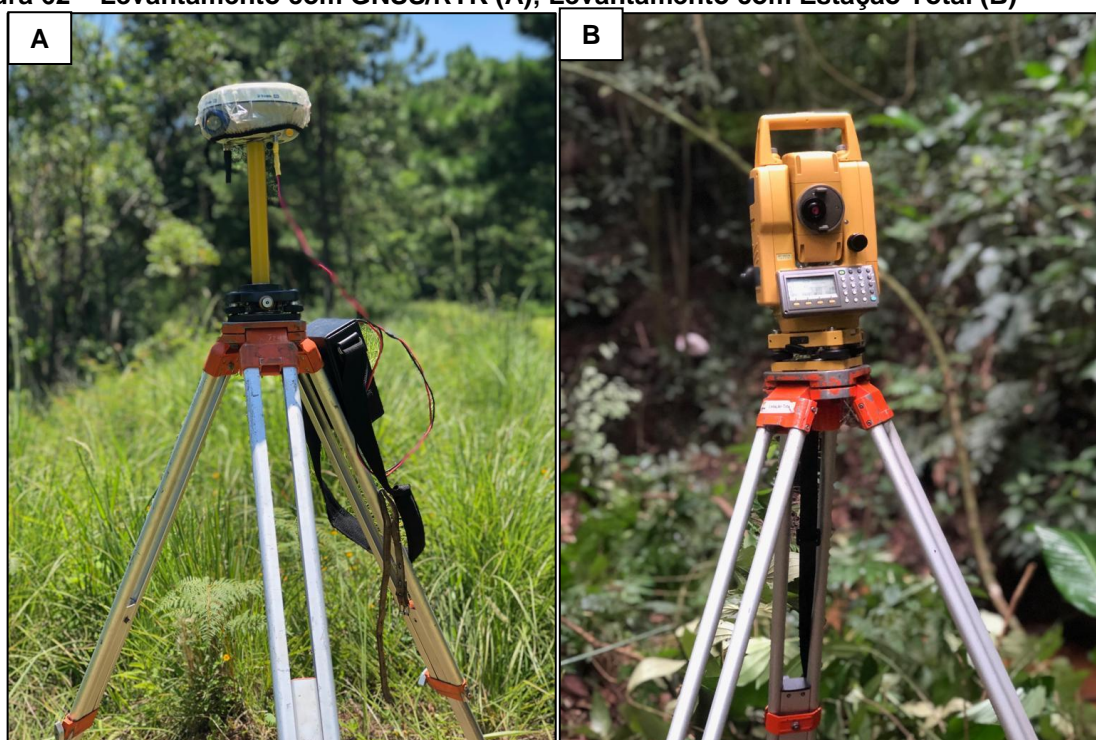
Figura 62 – Levantamento com GNSS/RTK (A); Levantamento com Estação Total (B)
