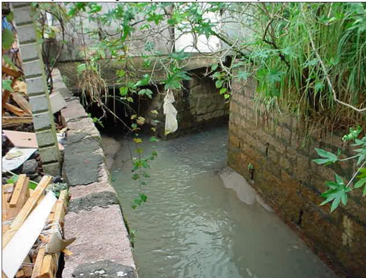
Figura 11 – Vista do rio Criciúma entre as ruas Henrique Lage e Cônego Miguel Giacca. Observe-se a canalização do curso d'água com paredes de pedra e construção em sua APP.
