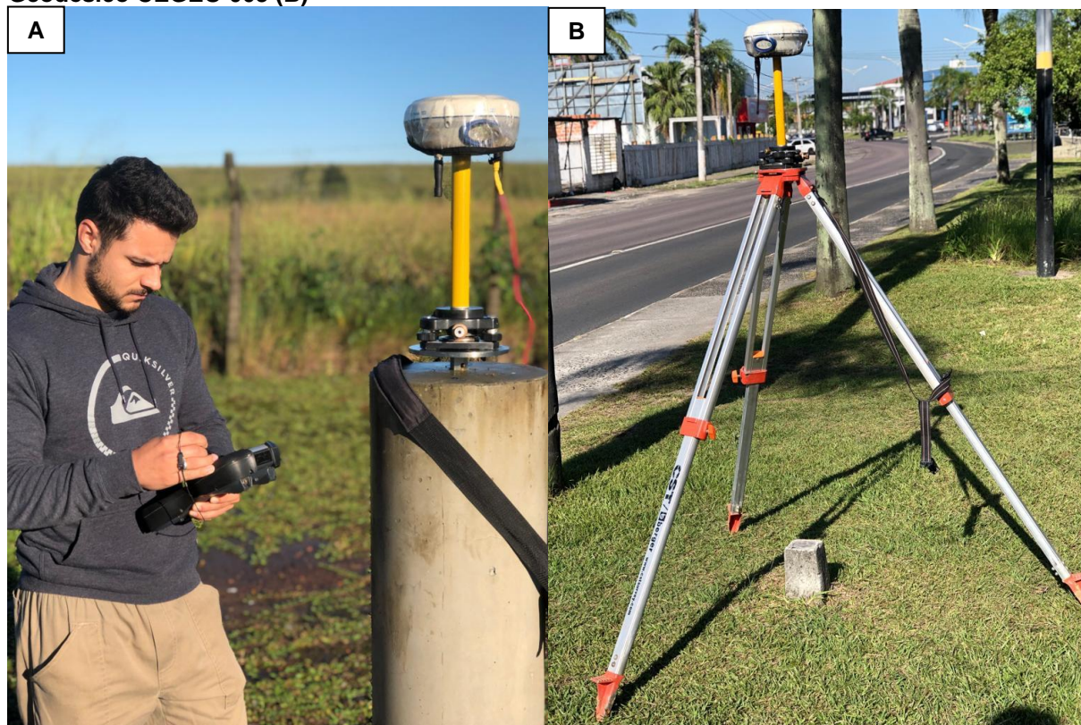
Figura 57 – Base do RTK posicionada sobre a Estação Geodésica SAT-99641 (A); Marco Geodésico CEGEO 003 (B)
