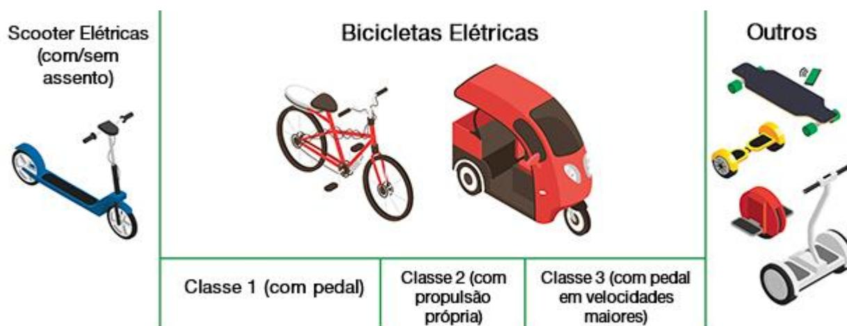
Figura 112: Exemplos de veículos usados na micromobilidade e suas classificações.
