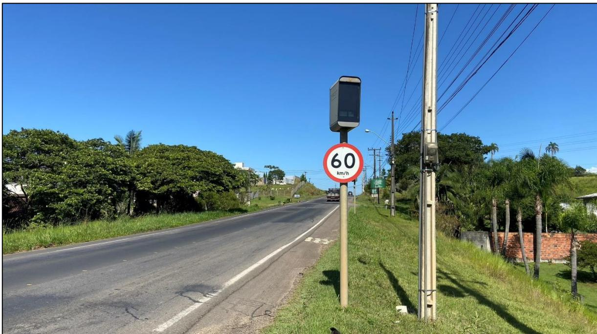
**Figura 65:** Exemplo de equipamento do tipo “controlador de velocidade” no município de Criciúma.
