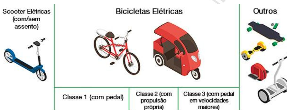
**Figura 103:** Exemplos de veículos usados na micromobilidade e suas classificações.
